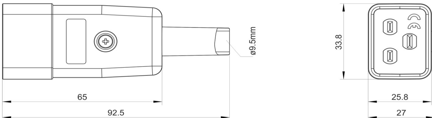
Abisolierung / Wire stripping: N 35 mm L 35 mm PE 45 mm
